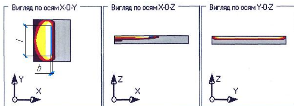
Рис. 1. Змодельований розподіл температурних полів в фотопластині за координатами x, y, z , в залежності від режимів обробки рухомих стрічковим електронним потоком: P_{\text{пит}} = 10 \cdot 10^3 \text{ Вт/см}^2 ; V_{\text{пот}} = 10 \text{ см/с}
